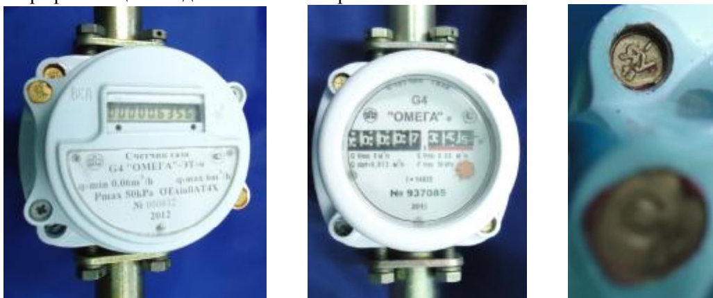
Фотографии общего вида и мест пломбировки счетчиков
